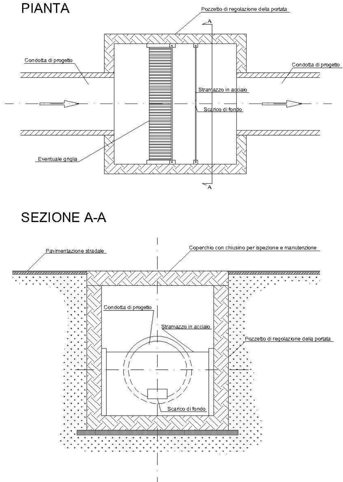
Figura 4.1: schema tipo per il manufatto di controllo dello scarico.
